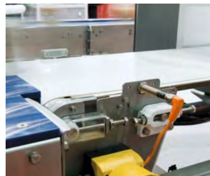
Безопасное обнаружение перемещаемых деталей на конвейерной ленте.
