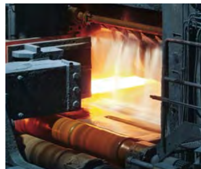
Обнаружение положения стальных слябов (заготовок) в прокатных станах.
